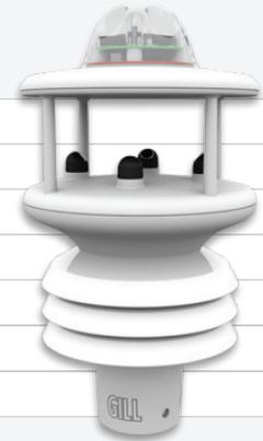
**Temperatura, humedad, presión.** Estación compacta sin partes móviles con protector solar. El resultado es un alto rendimiento en cada medición durante largos periodos de tiempo.
