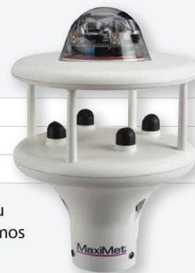
**Precipitación.** Un pluviómetro óptico integrado que detecta automáticamente el agua que golpea su superficie exterior y proporciona mediciones basadas en el tamaño y el número de gotas. Los algoritmos interpretan estos datos y simulan la salida de un pluviómetro de volcado en un formato de serie. El pluviómetro óptico no tiene partes móviles asociadas con cubetas basculantes.
