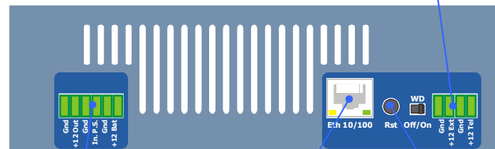
Connettore per alimentazione sensori e modem Connector for sensor and modem power
